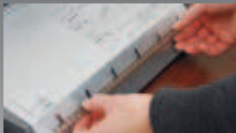
2. Umieść wybrany grzbiet na zaczepach z przodu bindownicy.
